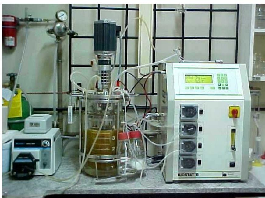
**Figura 9:** Biorreator Biostat B – B. Braun Biotech utilizado para a produção de biomassa celular e enzimas.
