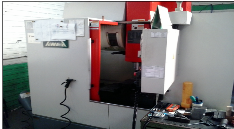
Figura 32 – Centro de usinagem vertical AWEA AF 610
