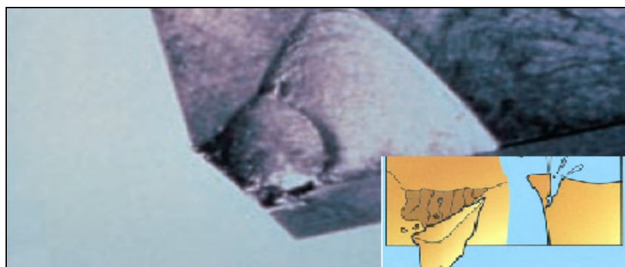
Figura 16– Quebra da ferramenta
