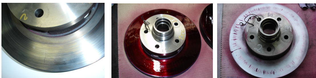
Figura 46 – Discos de freio com aplicação de líquido revelador de trincas.
