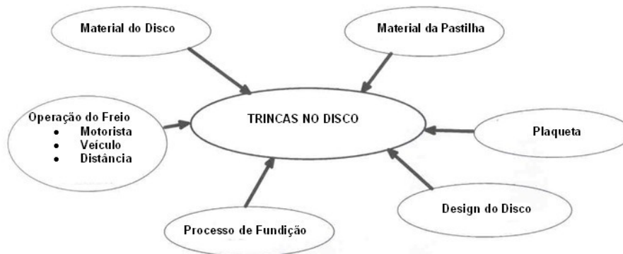
Figura 18 – Fatores responsáveis pelo aparecimento e trincas térmicas em discos de freio. [28]
