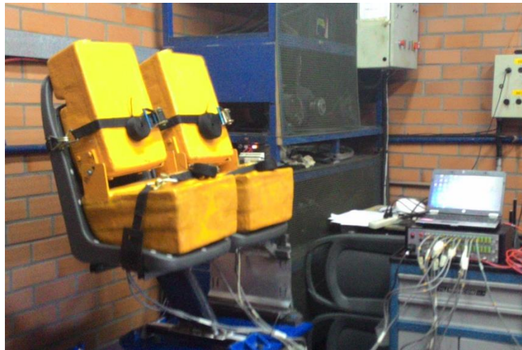
Figura 24 – Medição das tensões em teste de laboratório.
