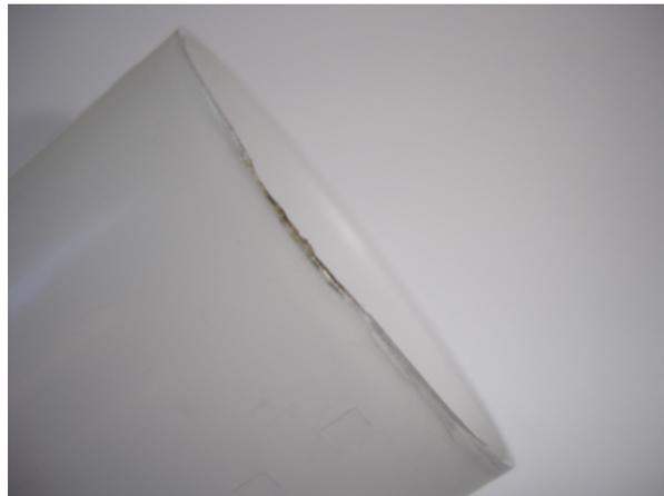
*Figura 44 - Falha no preenchimento da peça*
