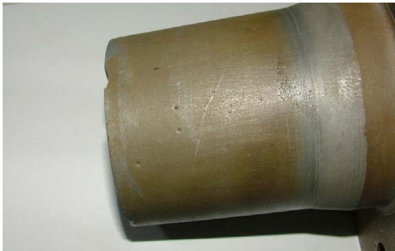
*Figura 51 - Degradação da superfície do macho de Resina*
