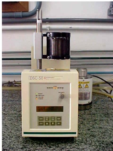
Figura 24 - Equipamento utilizado para análises de DSC [71]
