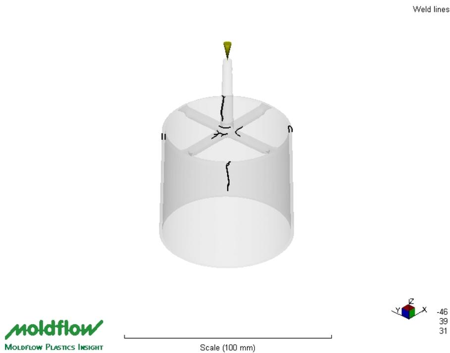
Figura 15 - Linhas de solda na configuração AISI P20 a 30°C
