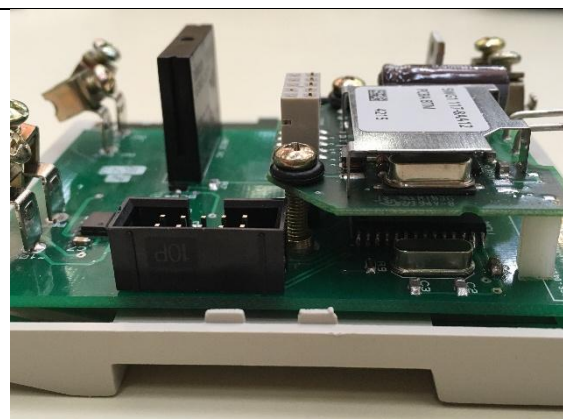
15 – Fixação da PCB TP-UART nos rebites da base da caixa plástica
