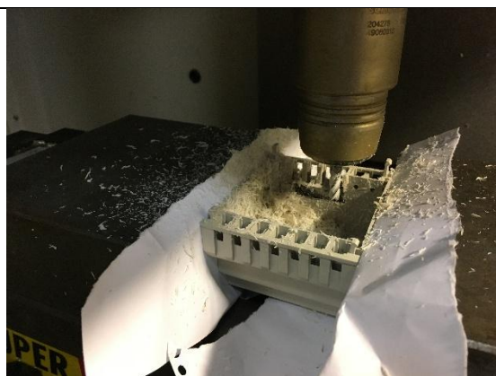
16 – Usinagem da estrutura da caixa Patola para encaixe da PCB TP-UART
