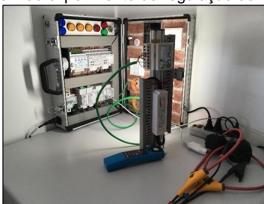
Figura 40 – Montagem do experimento de regulação de iluminação constante
