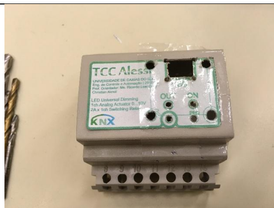
8 – Furação e usinagem da face superior da caixa plástica: utilização de adesivo para marcação
