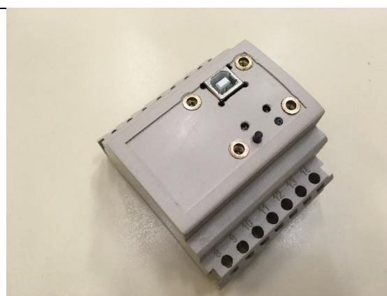
12 – Placa secundária fixada com 4 parafusos nos rebites com rosca interna
