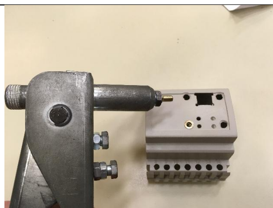
10 – Colocação de rebites com rosca interna
