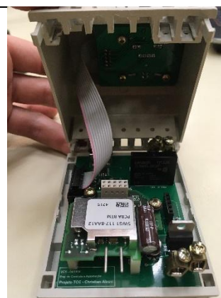
18 – Montagem e posicionamento das placas dentro da caixa
