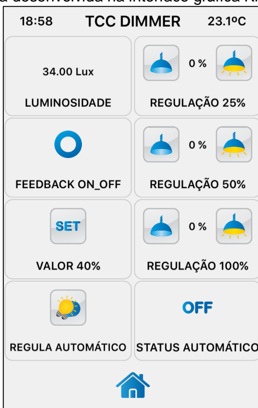
Figura 26 – Tela desenvolvida na interface gráfica KNX Z41 ZENNIO
