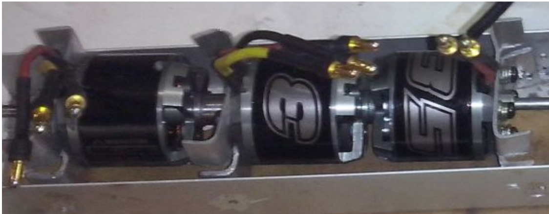
Figura 36 - Montagem dos geradores em eixo único
