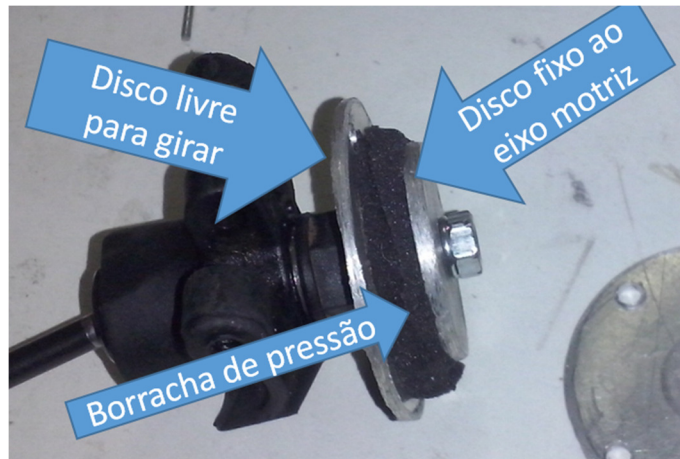
Figura 43 - Acoplamento tipo sanduíche
