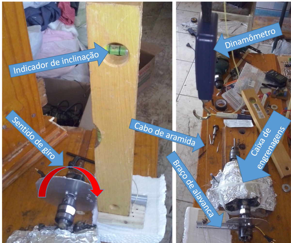
Figura 34 - Montagem de calibração da bancada de torque
