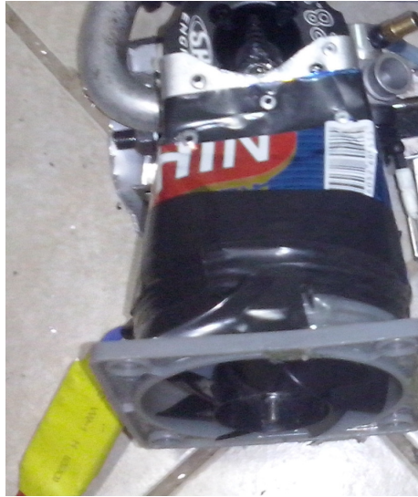
Figura 41 - Sistema de refrigeração forçada
