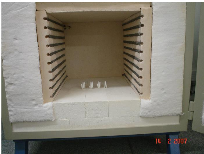
*Figura 3.9 – Câmara do forno elétrico Sanchis com molas pré-sinterizadas.*
