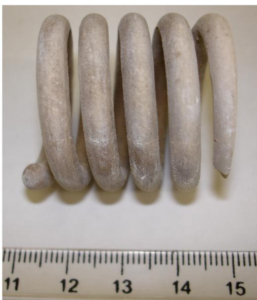
*Figura 4.9 – Mola cerâmica após extração de ligantes (250 °C).*
