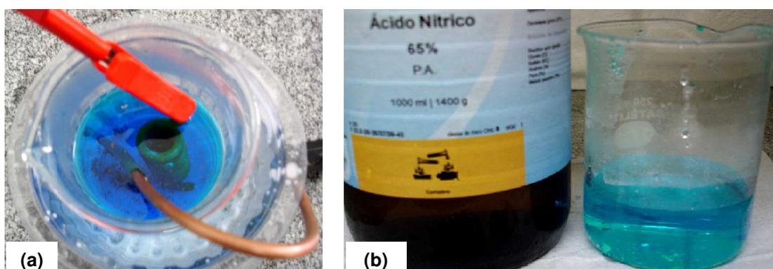
Figura 3.3 – Remoção do molde de cobre (a) por eletrólise e (b) com ácido nítrico.
