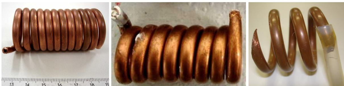
*Figura 4.2 – Moldes de cobre enrolados manualmente.*
