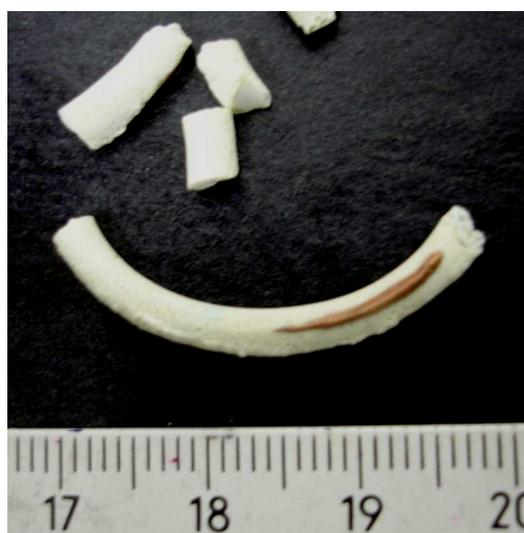
Figura 4.3 – Pedaços do tubo de cobre aderido na superfície da mola cerâmica.
