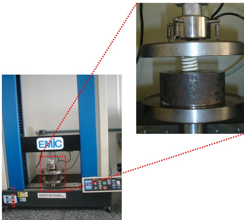
*Figura 3.14 - Máquina de ensaios universal EMIC; no detalhe está a célula de carga com a mola cerâmica, prontos para o ensaio.*
