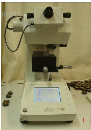
*Figura 3.13 - Micro-durômetro Shimadzu utilizado para medidas de dureza Vickers.*
