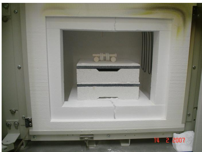
*Figura 3.10 – Câmara do forno Lindberg com molas sinterizadas.*
