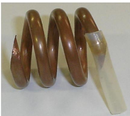
*Figura 3.1 – Molde feito com tubo de cobre.*
