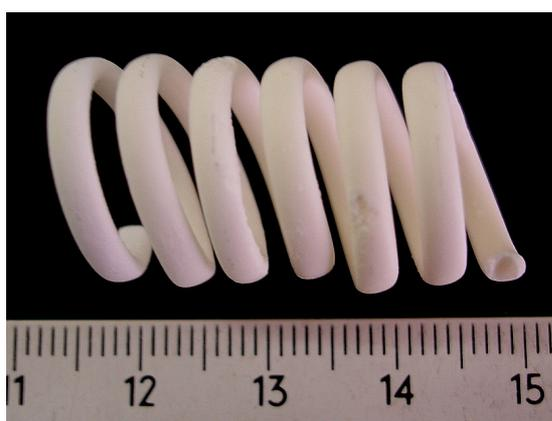
Figura 4.11 – Mola de alumina sinterizada com distorção lateral.
