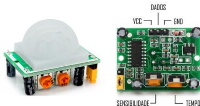
Figura 8 - Sensor Infra Vermelho DYP-ME003 – Vista Frontal
