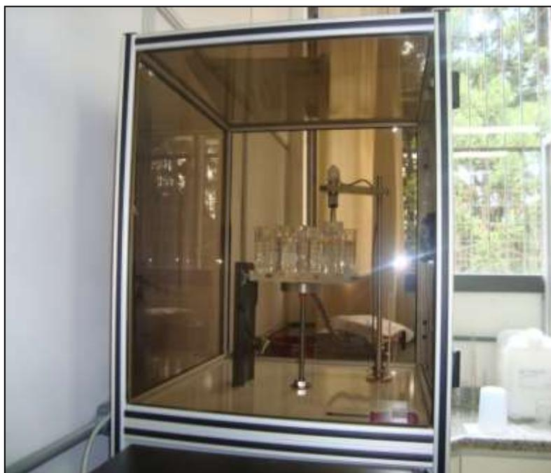
**Figura 15** – Equipamento para preparação das multicamadas dos filmes.
