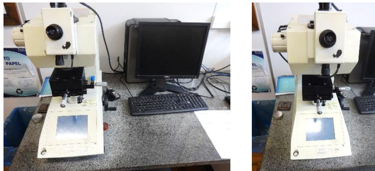
Figura 43 - Microdurômetro Shimadzu HMV-2 utilizado para análises de microdureza Fonte: do autor
