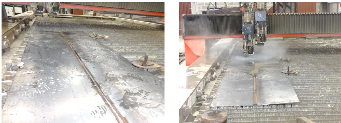
Figura 42 - Processo de corte a jato d'água dos corpos de prova
