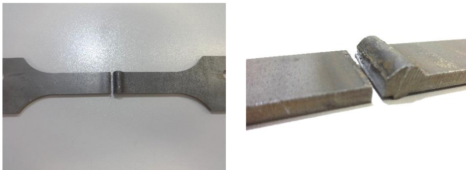
Figura 72 – Fratura ocorrida na ZTA em amostra fadigada Fonte: do autor
