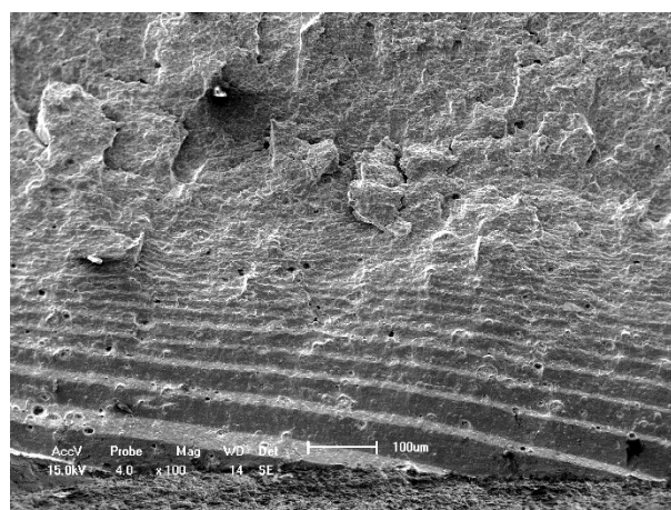
Figura 29 - Estrias na superfície de fratura Fonte: do autor
