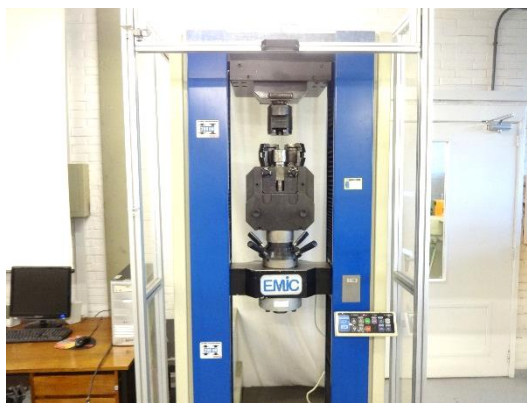
Figura 46 – Máquina EMIC DL 20000 utilizada para ensaio de tração
