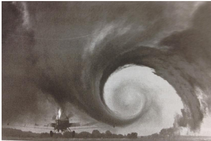
Figura 9: Vórtices de ponta de asa produzidos por um avião agrícola voando sob o ar enfumaçado
