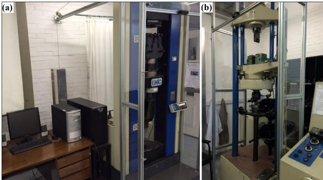
Figura 35 - Equipamento para ensaio de (a) tração e (b) dobramento.
