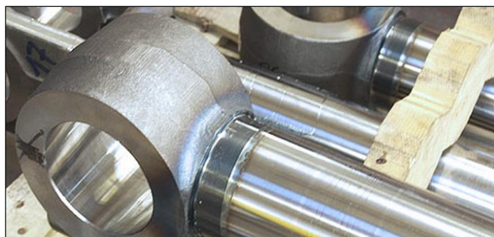
Figura 11 - Emprego da soldagem por fricção em um conjunto haste do cilindro hidráulico.
