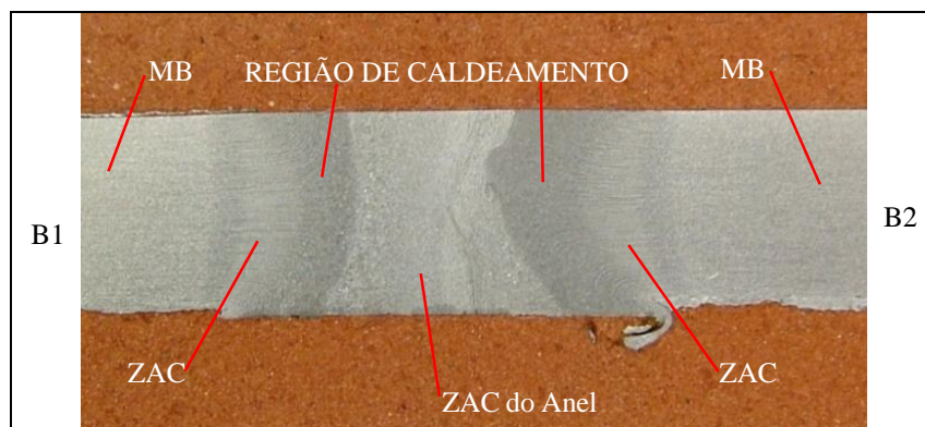
Figura 47 - Macrografia do CP identificado por FM do processo de soldagem FW.
