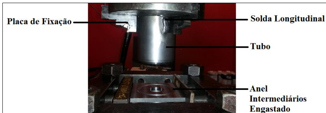
Figura 25 - Representação do posicionamento e fixação dos tubos e anel intermediário para soldagem FW.
