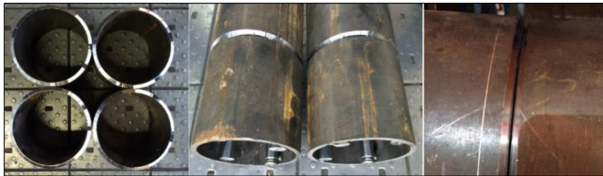
Figura 20 - Junta a serem soldadas no processo GMAW.
