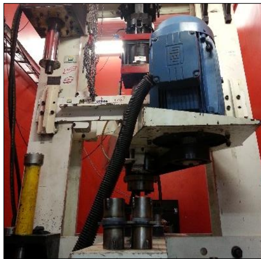
Figura 24 - Equipamento para soldagem FW.
