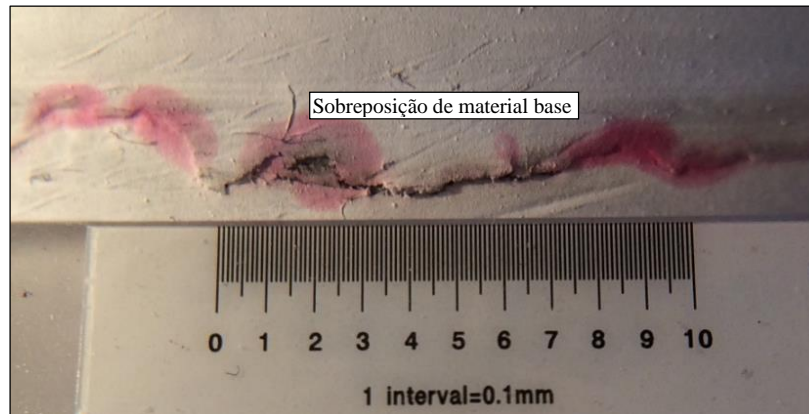
Figura 41 - Ensaio de líquidos penetrantes no processo FW.
