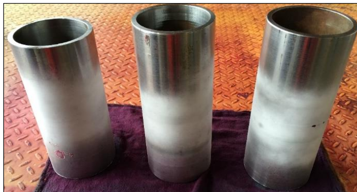
Figura 34 - Ensaio de líquidos penetrantes nos processos de soldagem GMAW, LW e FW.
