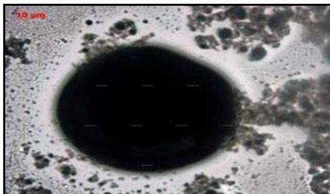
Com relação à massa específica dos grânulos, após a análise de quatorze amostras foi encontrado o resultado de  $1.050 \text{ kg.m}^{-3}$ , com um desvio padrão de  $43 \text{ kg.m}^{-3}$ . A velocidade de sedimentação também foi avaliada, obtendo-se uma média de velocidade de sedimentação de  $0,040 \text{ m.s}^{-1}$ .
