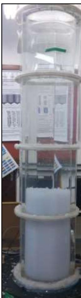
A fração volumétrica de gás experimental dentro do reator foi estimada pelo método do gás *hold up*. Para tal, a altura encontrada do líquido foi medida, em seguida foi ligado o gás e a altura que o líquido atinge foi novamente medida. A diferença entre as alturas foi calculada, e o volume ocupado pelo gás foi calculado por esta diferença. Em seguida foi calculada a fração volumétrica considerando o volume útil do reator.
