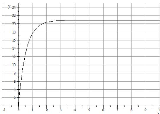
**Questão 08.** Quando uma tensão elétrica constante  $U$  (em volts) é aplicada a um circuito constituído por um resistor (de resistência  $R$ , em ohms) e um capacitor (de capacitância  $C$ , em farads) ligados em série, a corrente elétrica  $i$  (em ampères) é dada por:  $i(t) = \frac{U}{R} e^{-R/Ct}$ , onde  $t$  é o tempo (em segundos) transcorrido desde o momento da aplicação da tensão.
