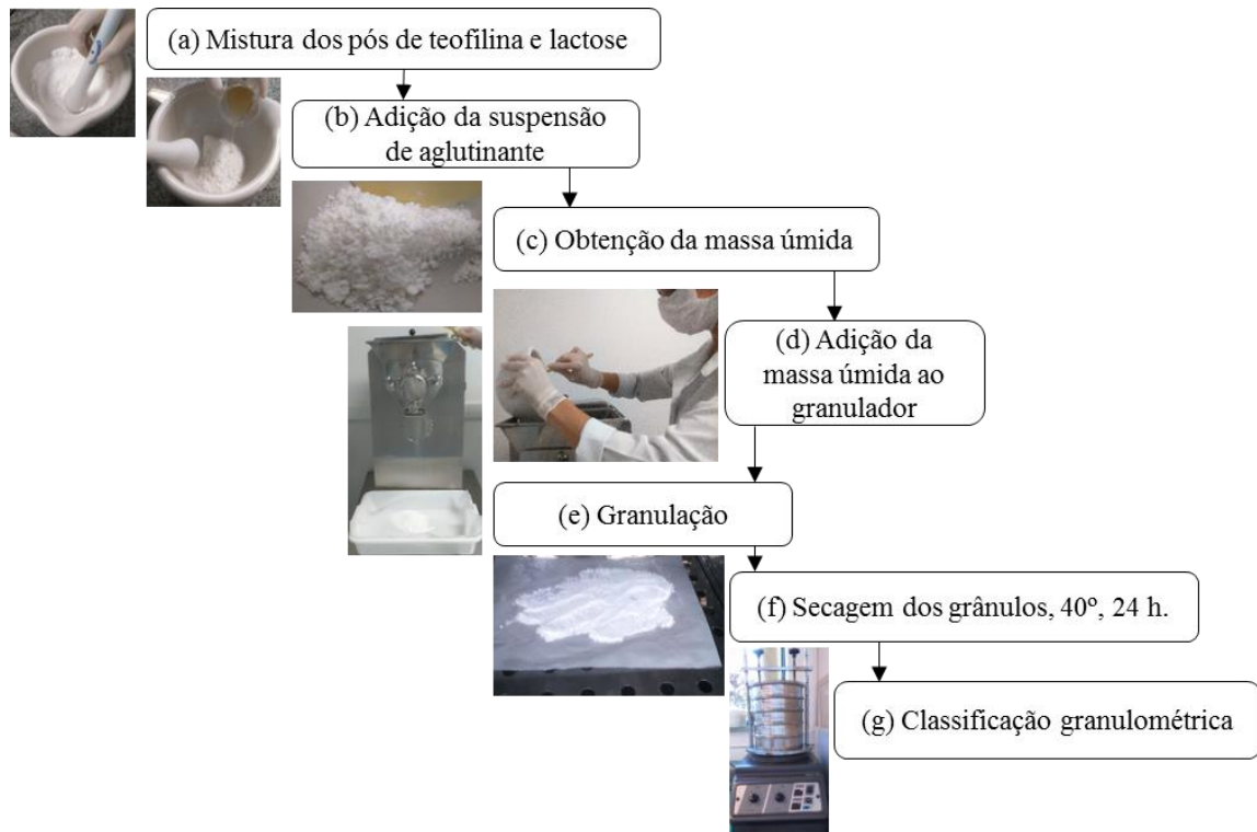
Figura 22. Esquema das etapas do processo de granulação dos pós de teofilina e lactose utilizando nanofibras de celulose como aglutinante.
