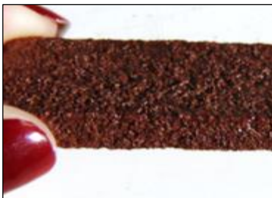
Figura 3 – Compactado produzido com abrasivo de micro esfera de vidro. (35, p. 57)
