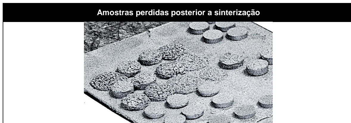
Figura 42 – Aparência posterior à sinterização do grupo A e grupo B – Diâmetro das amostras ~10 mm
