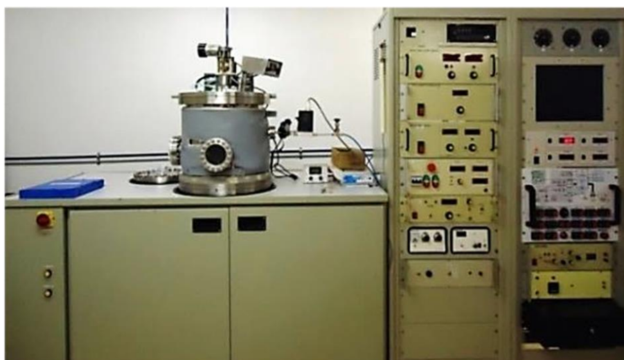
Figura 12: Equipamento de Ion Plating utilizado para a modificação superficial das amostras de Titânio cp e aço inox AISI 304.
