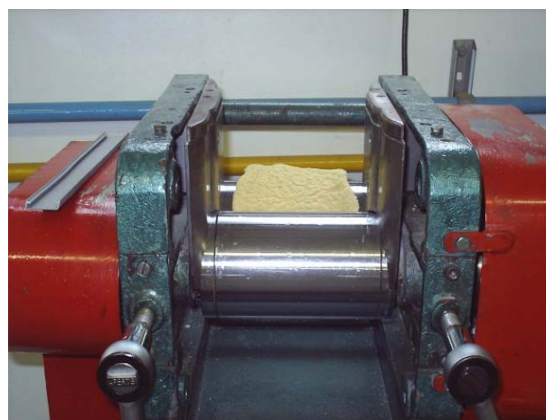
(b) dispersão do agente expensor e obtenção da pré-forma
