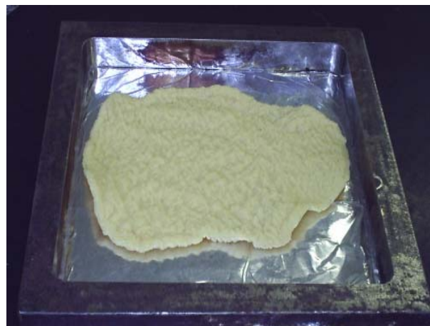
(d) preenchimento parcial do molde
