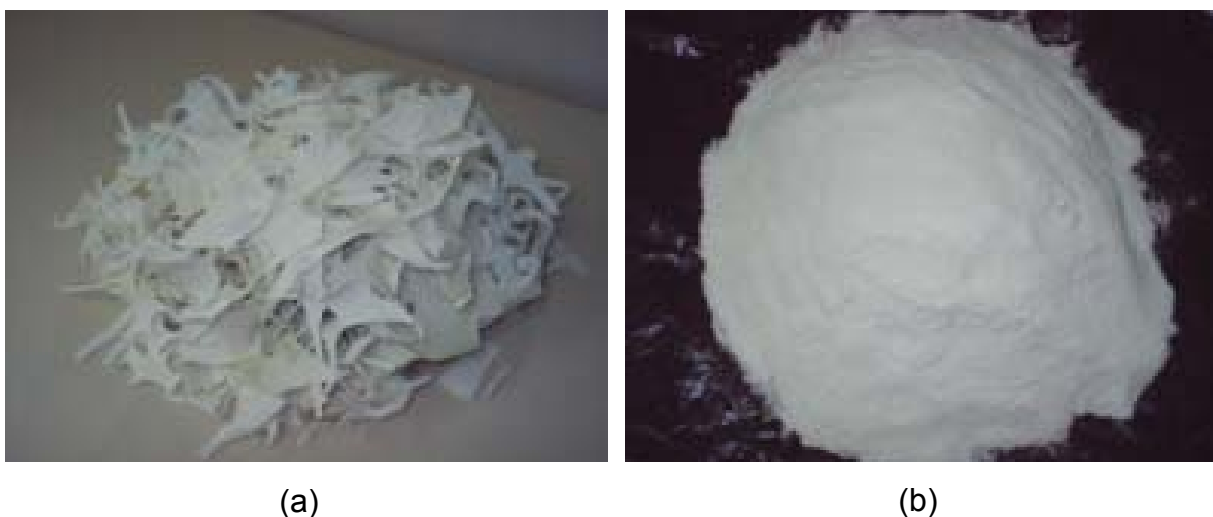
Figura 12 - Amostras de SBR-r: (a) SBR-r retalhos; (b) SBR-moído (24-100 mesh)
