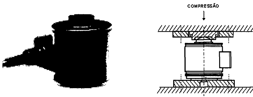
Figura 2.18- Forma e montagem da célula de carga do tipo apoio de tanque
