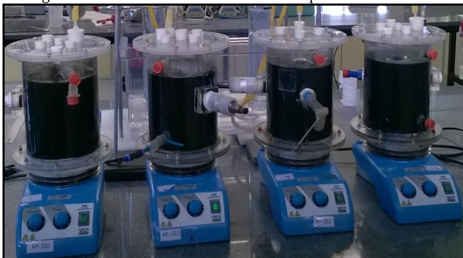
Figura 10 - Reatores de bancada utilizados para o teste da AME
