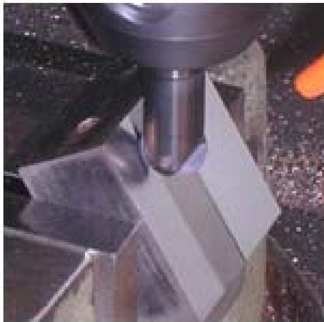
Figura 57- Fotografia da ferramenta e CP durante a execução do ensaio na estratégia vertical ascendente (VS)
