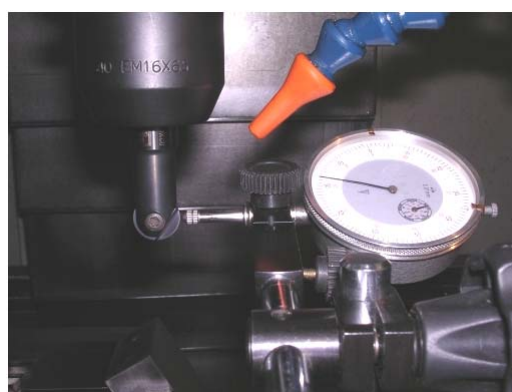
Figura 56- Fotografia da verificação do batimento da ferramenta
