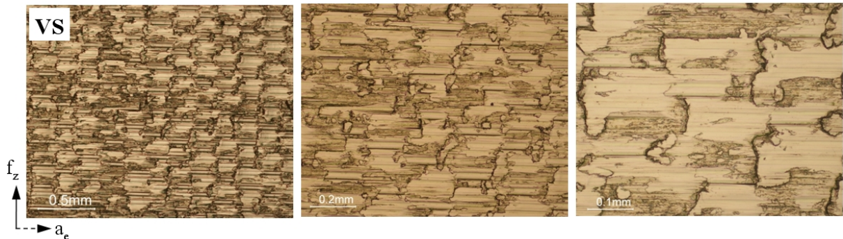
Figura 69- Fotografias da textura estratégia VS, com magnificação de 50, 100 e 200 X
