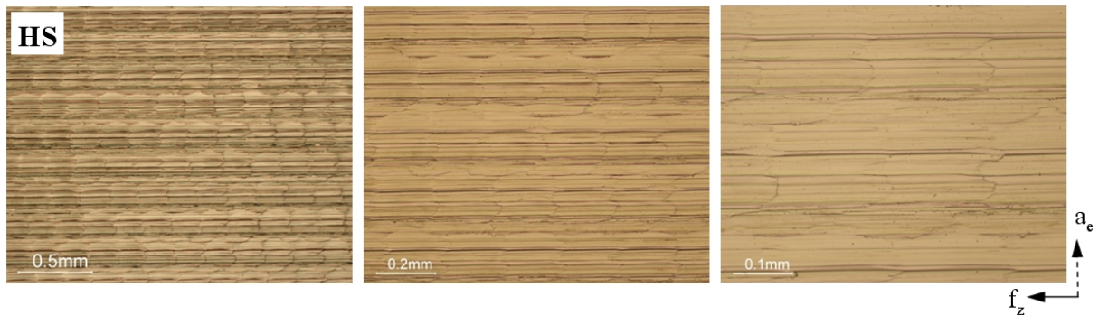
Figura 67- Fotografias da textura estratégia HS, com magnificação de 50, 100 e 200 X
