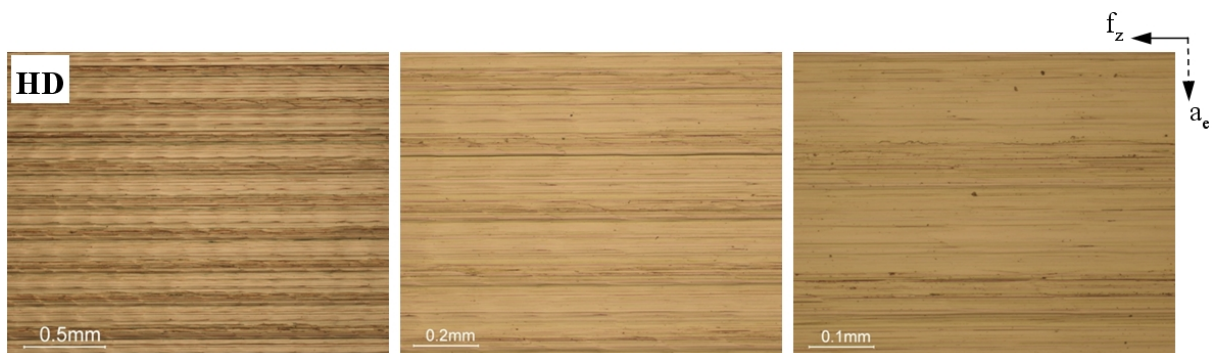
Figura 68- Fotografias da textura estratégia HD, com magnificação de 50, 100 e 200 X
