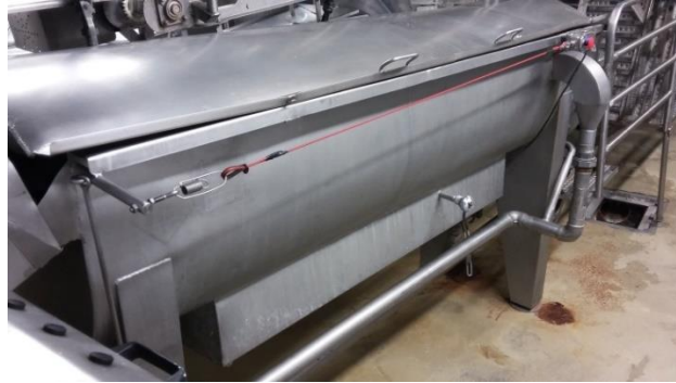
Figura 4.4 - Chiller de escalda de pés analisado
