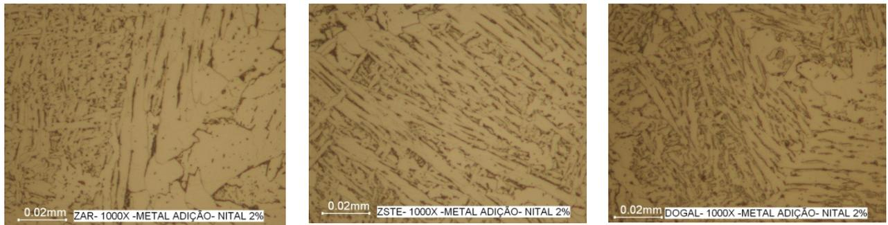
**Figura 33: Micrografia do cordão de solda com ampliação de 1000X para os três casos: (a) ZAR (b) ZSTE e (c) DOGAL.**
