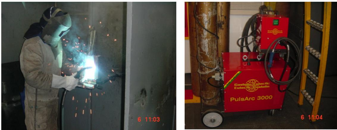
**Figura 17 Lado esquerdo: Trabalhador soldando um tubo para construção de carrocerias de ônibus. Lado direito: Equipamento de solda MIG/MAG empregado neste trabalho.**
