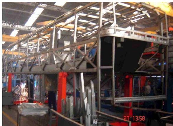
**Figura 5:**Partindo da esquerda no sentido horário: Soldagem da parte lateral da carroceria do ônibus, soldagem da parte frontal, Carroceria em estagio final de construção e finalmente o ônibus pronto.
