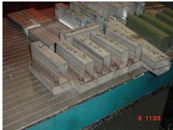
**Figura 21:** Diferentes tubos de aço empregados na fabricação dos corpos de prova
