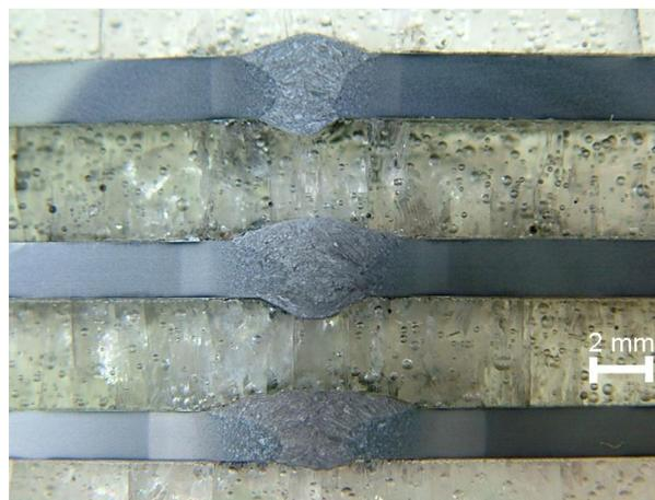
**Figura 28:** Fotografia da região da solda para os três aços submetidos à solda e analisados por micrografia. De baixo para cima: DOGAL800, ZSTE380 e ZAR230.
