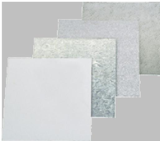
**Figura 7: Exemplos de acabamentos de aços galvanizados influenciados pela camada de zinco depositada na superfície.**
