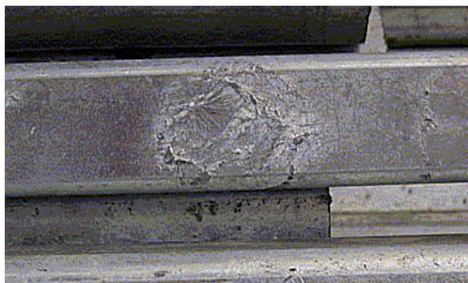
**Figura 8 :Perfil com revestimento por banho de zinco.**
