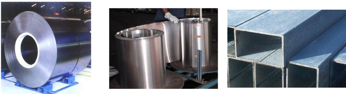
**Figura 4:** Esquema da fabricação de tubos retangulares utilizados na fabricação das carrocerias de ônibus. Esquerda: uma bobina de aço. Centro: Chapas sendo geradas a partir das bobinas de aço. Direita: tubos formados das chapas de aço.
