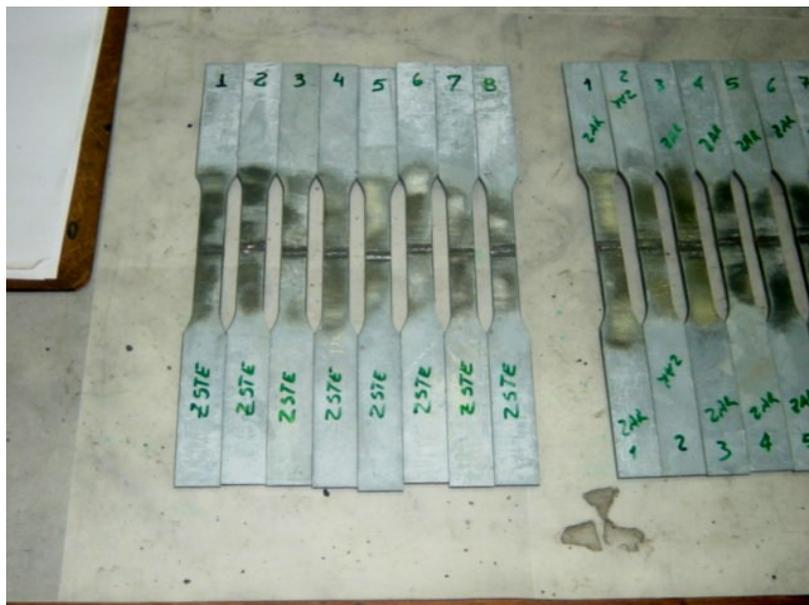
Figura 277: Foto de corpos de prova com solda transversal do aço ZSTE380.
