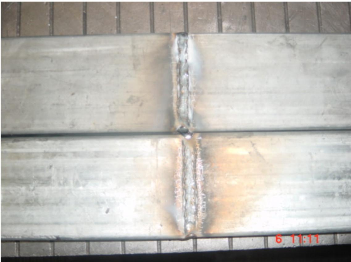
**Figura 25: Tubos de aço após serem cortados e novamente unidos pelo processo de soldagem MIG/MAG.**
