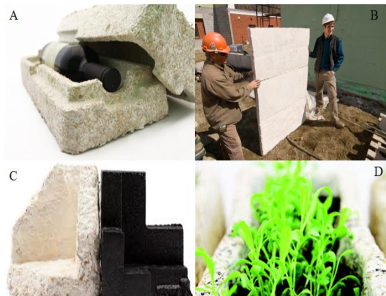
Figura 2 - Aplicações das bioespumas desenvolvidas a partir da biomassa fúngica (A) embalagens para bebidas; (B) chapas para construção civil; (C) cantoneiras para embalagens de eletrodomésticos; (D) bases para o crescimento de mudas de interesse agrônômico.
