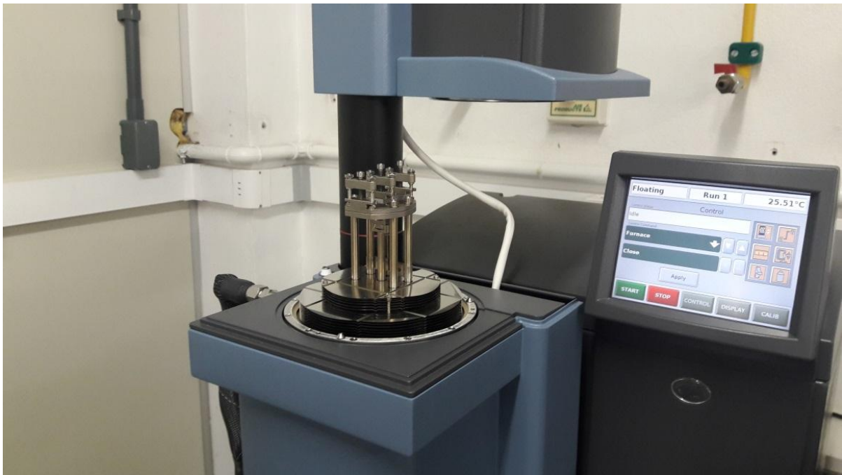
Figura 9. Clamp de viga dupla ( dual cantilever ).
