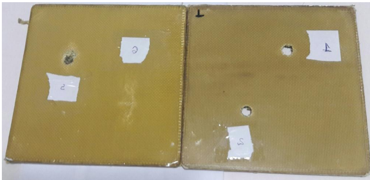
Figura 35. Compósito de resina éster-vinílica e aramida S745G tratada após impacto balístico.
