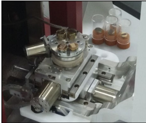
Figura 15 - Amostras da membrana acopladas ao MEV Mira 3
