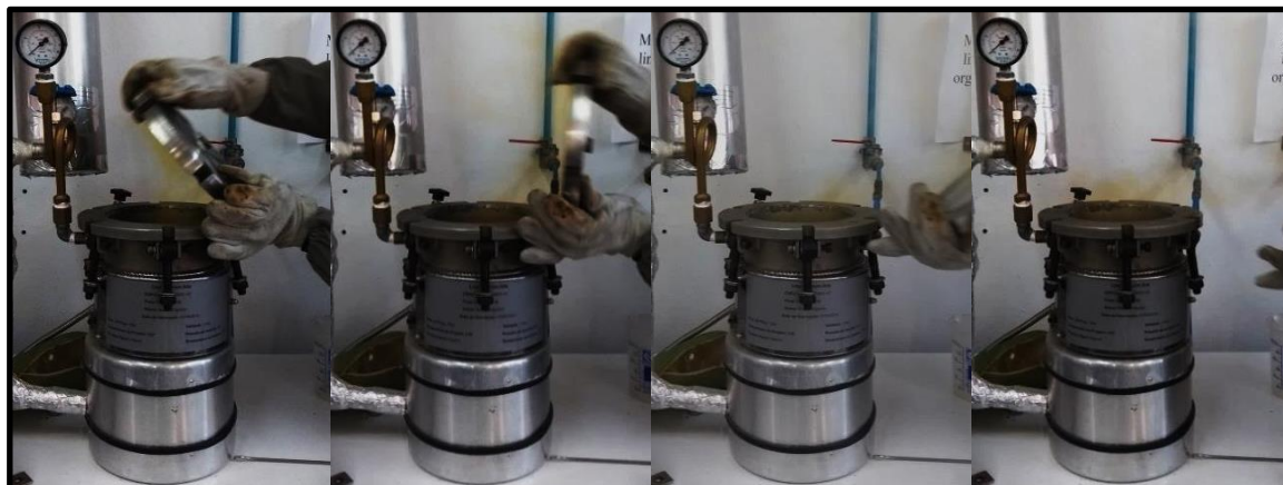
Figura 19 - Imagens da abertura do reator evidenciando a formação de \text{NO}_2
