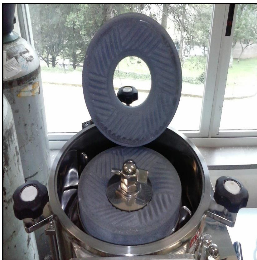
Figura 16 - Moinho de fricção ultrafina (pedras abertas mostrando o seu interior)
