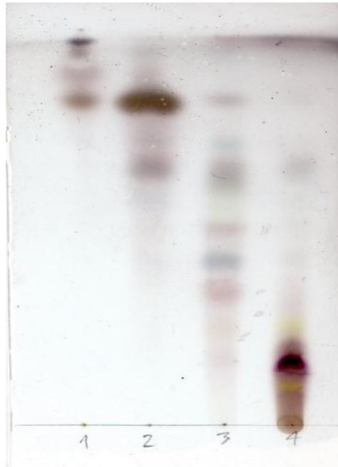
**Figura 9.** Cromatograma de Camada Delgada das 4 frações obtidas da VLC (Vacuum Liquid Chromatography). Sulfato de cobre ( $\text{CuSO}_4$ ) como revelador universal. As frações 1, 2, 3 e 4 foram obtidas a partir da extração com solventes de polaridade crescente: hexano, hexano:acetato de etila (80:20), hexano:acetato de etila (50:50), acetato de etila, respectivamente.
