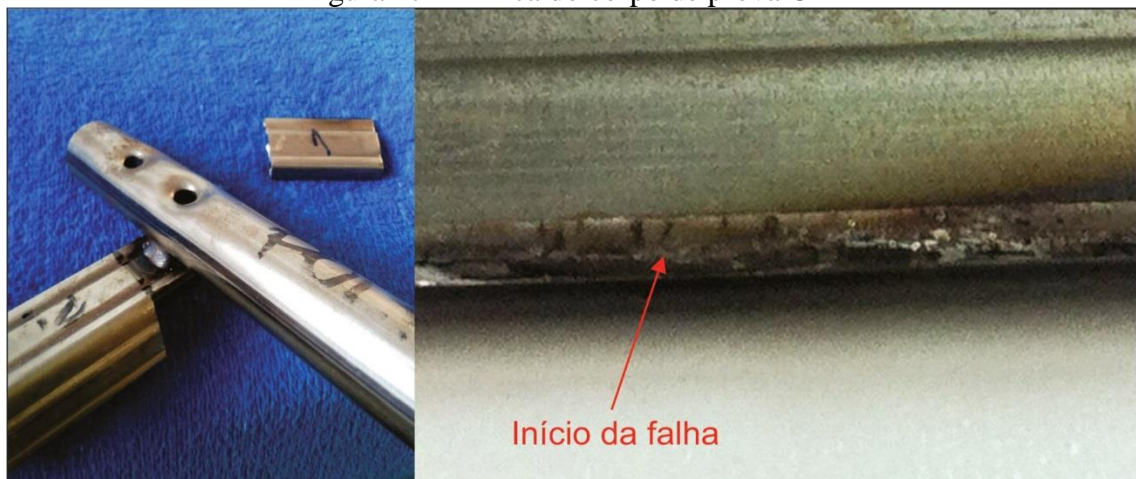
Figura 27 – Trinca do corpo de prova CP1
