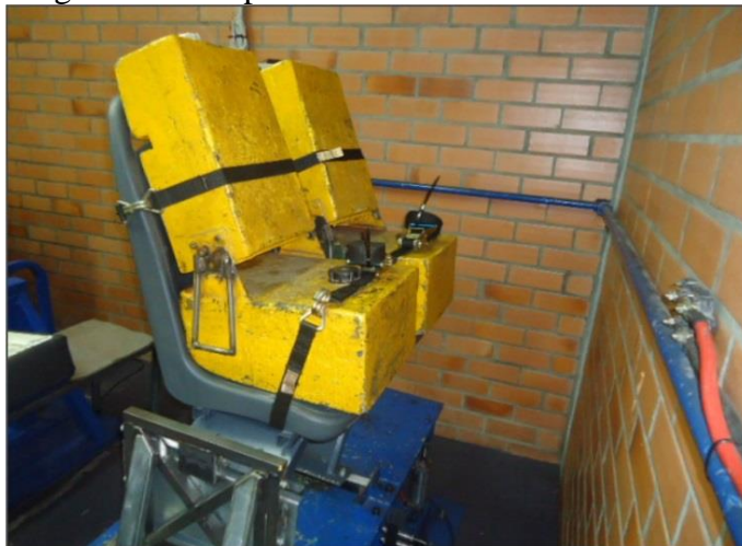
Figura 23 – Dispositivo de ensaio de durabilidade
