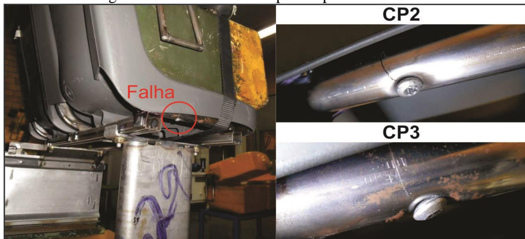
Figura 28 – Trincas dos corpos de prova CP2 e CP3
