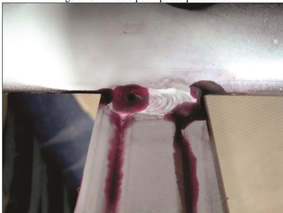
Figura 25 – Ensaio por líquidos penetrantes
