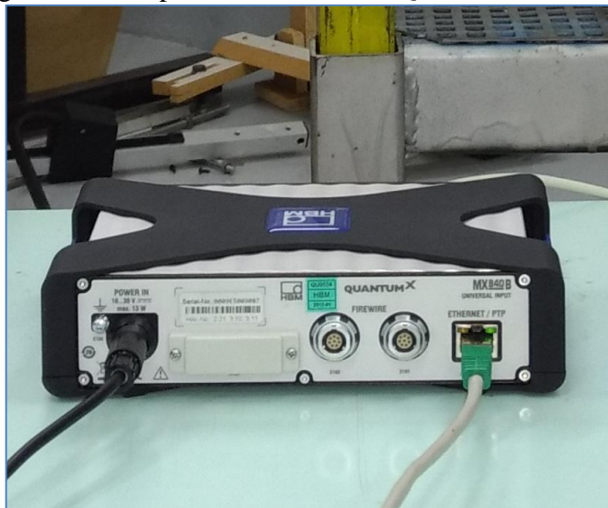
Figura 31 – Amplificador universal QuantumX MX840B.
