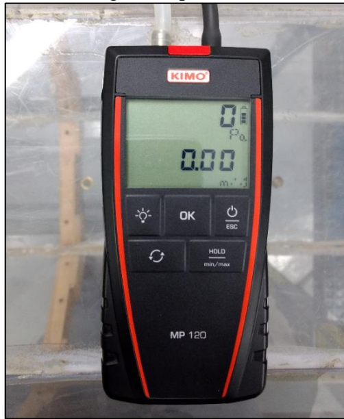
Figura 28 – Manômetro digital de pressão diferencial MP-120 Kimo
