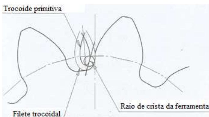
Figura 16 – Trocoide no dente de uma engrenagem
