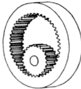
Figura 03 – Engren. e eixos paralelos que giram no mesmo sentido
