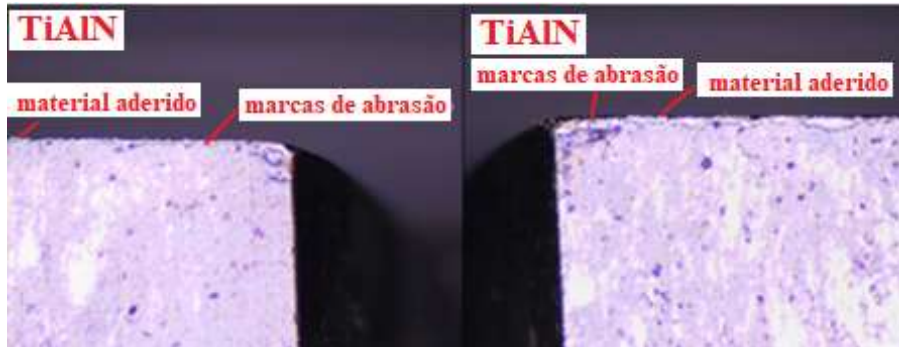
Figura 55 – Caracterização do desgaste na condição de revestimento TiAlN – réplica
