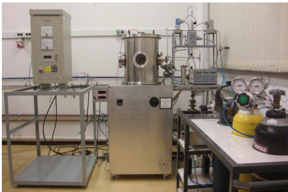
Figura 8: Dispositivo para deposição PEVCD localizado no LESTTII na UCS.
