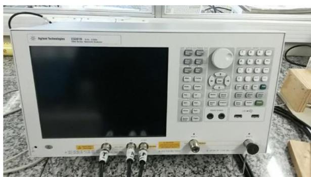
Figura 23. Analisador de Rede E5061B (Fonte: O Autor).
