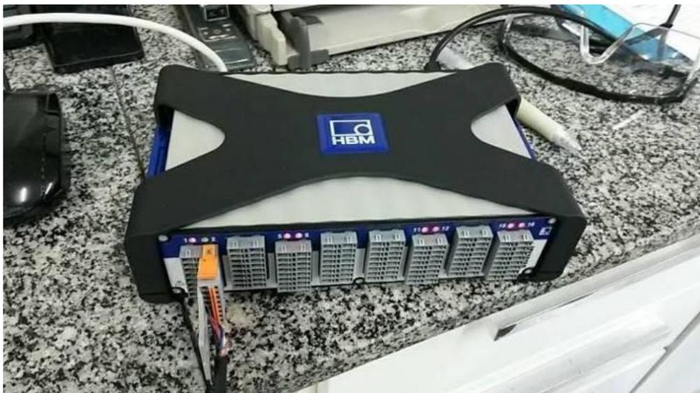
Figura 29. Placa de aquisição de dados QuantoX da HBM (Fonte: O Autor)
