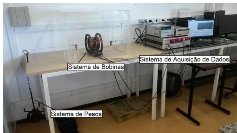
Figura 18. Foto da bancada de ensaios de tração utilizada para os ensaios de tração no LCM (Fonte: O Autor).
