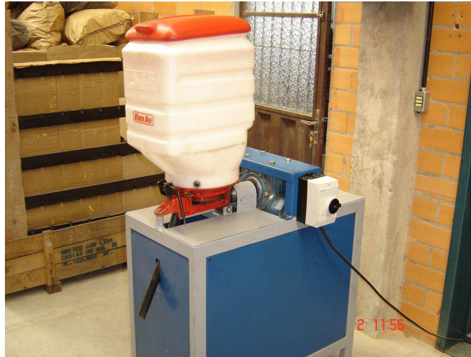
Figura 3.2 – Equipamento adaptado para simulação de plantio
