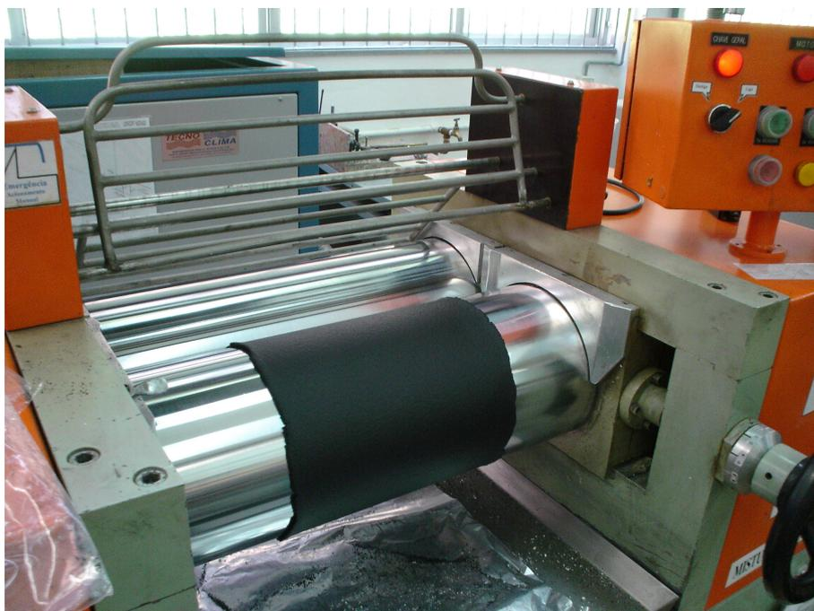
Figura 9: Incorporação do SBR-r e aceleração das misturas no misturador de rolos.
