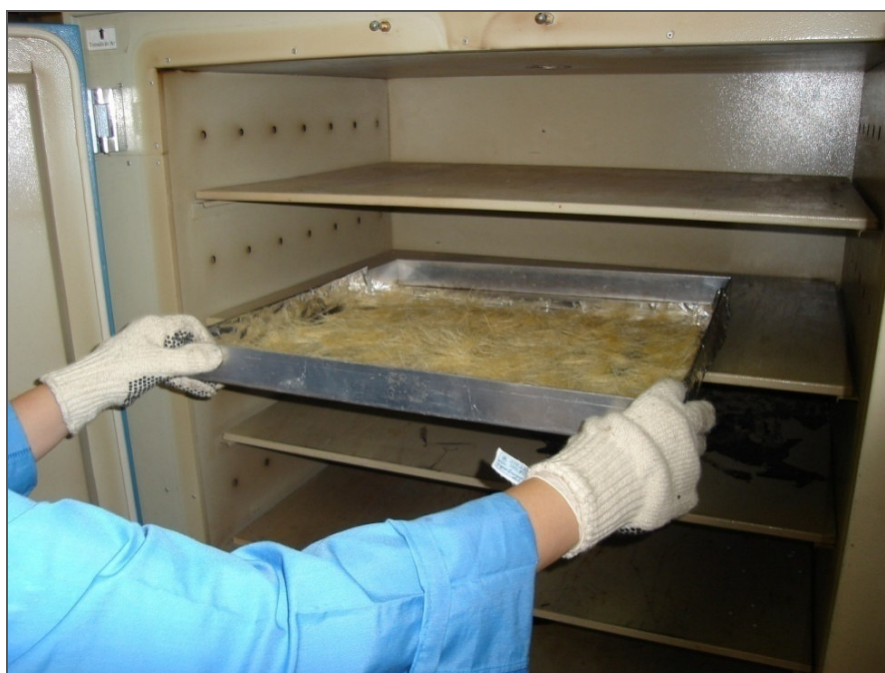
Figura 3.11 – Processo de secagem das fibras naturais
