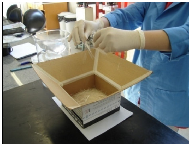
Figura 3.4 – Processo de produção de mantas por deposição manual (Métodos Manual e Manual-lav)
