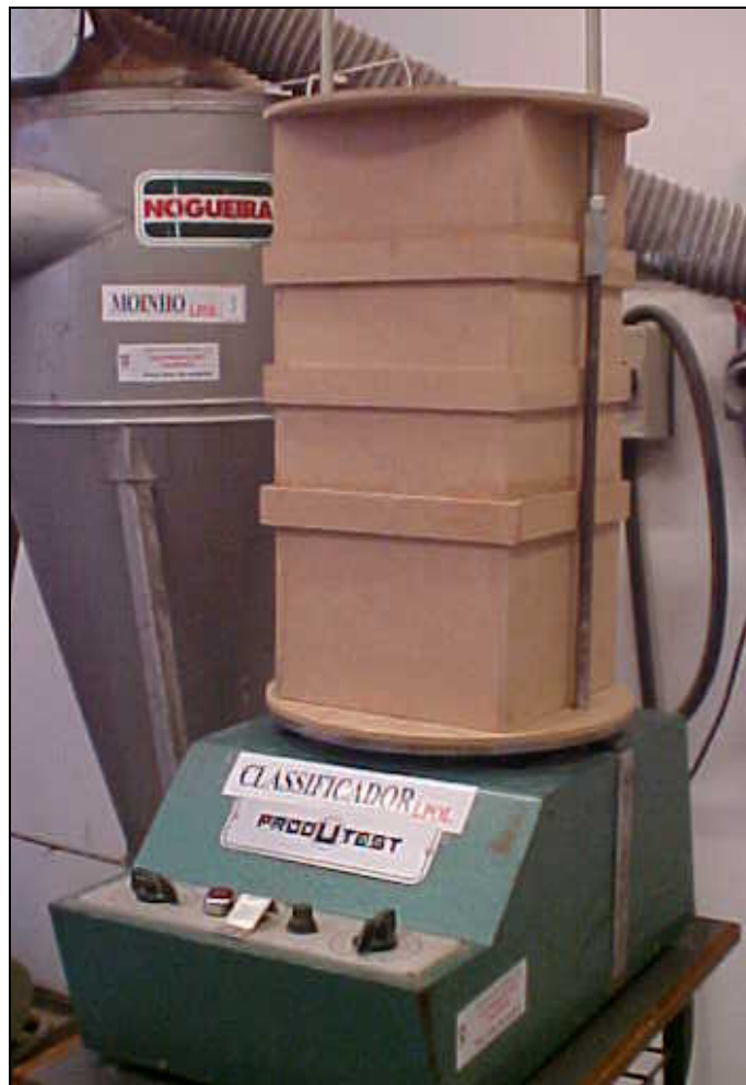
Figura 3.10 - Dispositivo para o método de deposição de fibras em meio vibracional (Método Vibracional)
