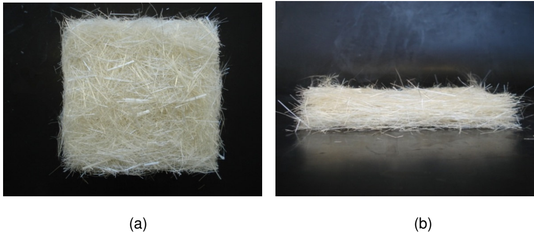
Figura 4.19 – Manta (50% vidro / 50% sisal) produzida pelo método Manual e Manual-lav (a) vista superior (b) vista lateral
