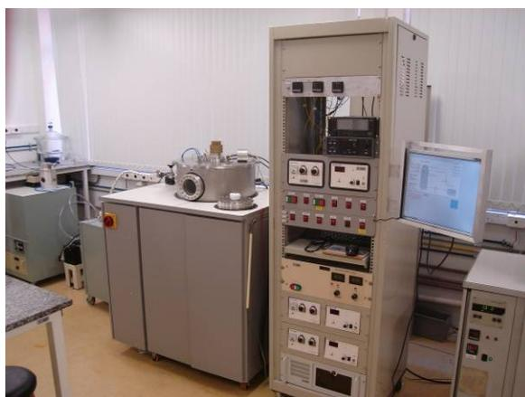
Figura 21 - Equipamento de deposição de filmes finos por PVD-*Magnetron Sputtering* no LESTT da UCS.
