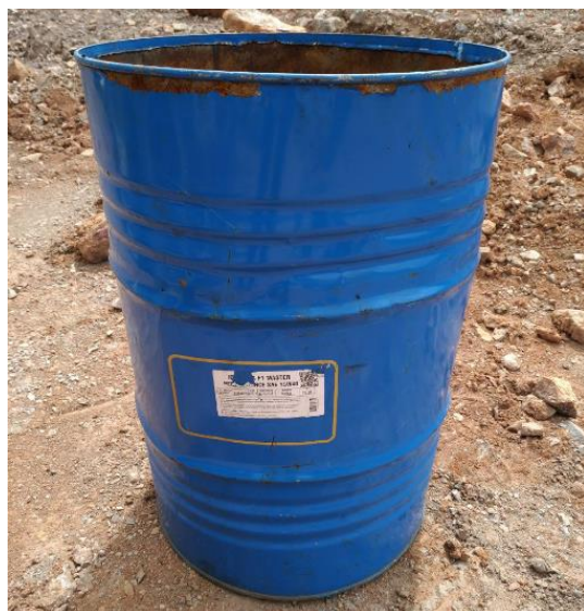
(e) Tonel de 200 L para verificação de vazão antes de cada teste
