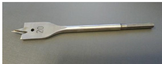
(c) Broca utilizada para furação do tubo
