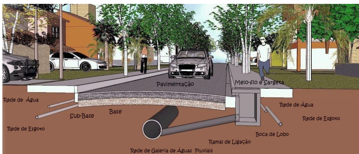
Figura 3 – Representação de um sistema de drenagem clássico posicionado no eixo da via
