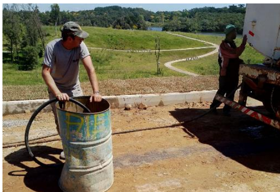
(a) Teste da mangueira flexível com enchimento do tonel de 200 L
