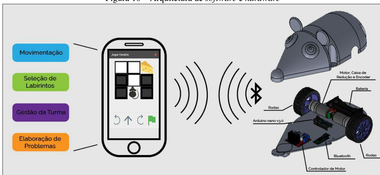
Figura 10 – Arquitetura de software e hardware
