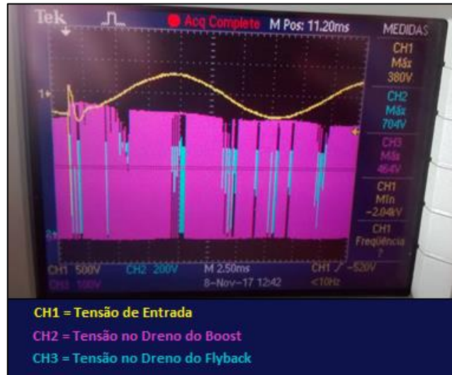
Figura 39 - Formas de Onda para Sobretensão entre Terminais Fase-Terra na Amostra 2.
