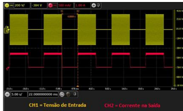
Figura 47 - Resultado do Ensaio de Interrupção de Tensão.
