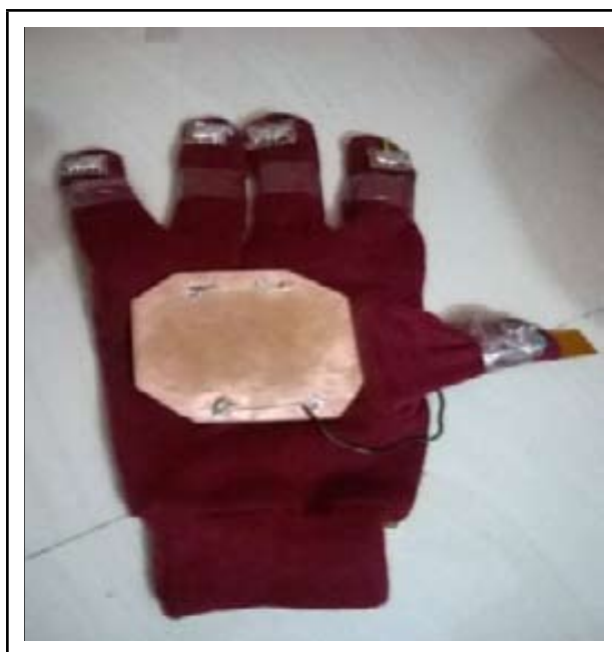
Figura 4 – Protótipo de luva com superfícies condutivas. O contato dos dedos com a área central da mão caracteriza diferentes variações de gestos.
