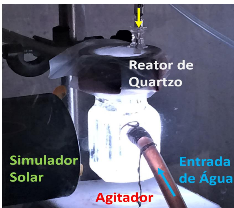
Figura 12 – Sistema de ensaios fotocatalíticos utilizado para a degradação do IBU.
