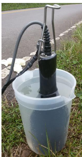
Figura 11. Equipamento utilizado para medir parâmetros in situ da água coletada no Arroio Belo.
