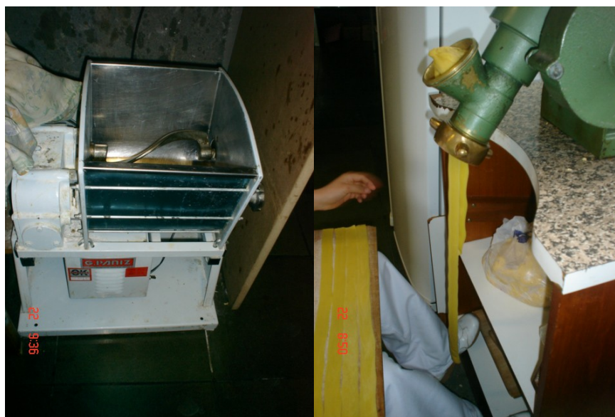
Foto 11 – Máquina de preparar a massa. Foto 12 – Máquina para espichar a massa e fazer as tiras. Fonte: Fotos da pesquisadora
