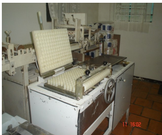
Fotos 14, 15, 16 e 17 - Máquina de fechar Agnolini inventada pelo Sr. Nelson Giulian. Fonte: Fotos da pesquisadora.
