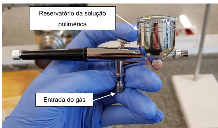
Figura 2 - Fotografia do airbrush comercial utilizado na fabricação das micro/nanofibras [o autor].
