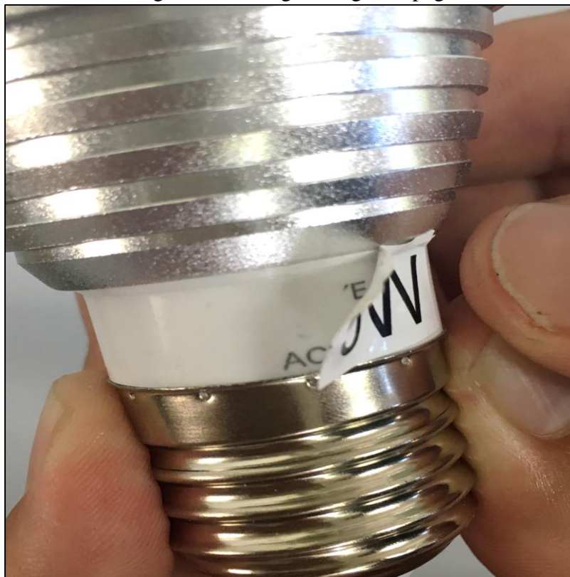
Figura 4 – Voltagem original apagada
