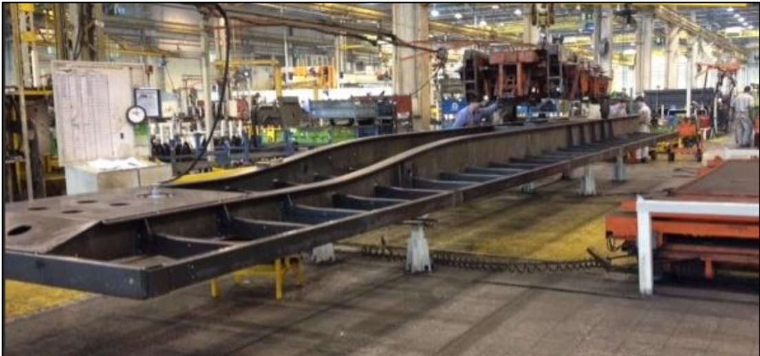
Figura 13 - Posto de montagem suspensão
