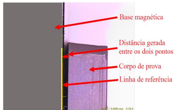
Figura 38 – Medição do empenamento em um corpo de prova liso
