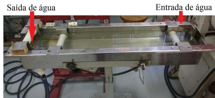
Figura 35 – Calha utilizada para o resfriamento dos corpos de prova sujeitos à condição pós-moldagem restrição física + água
