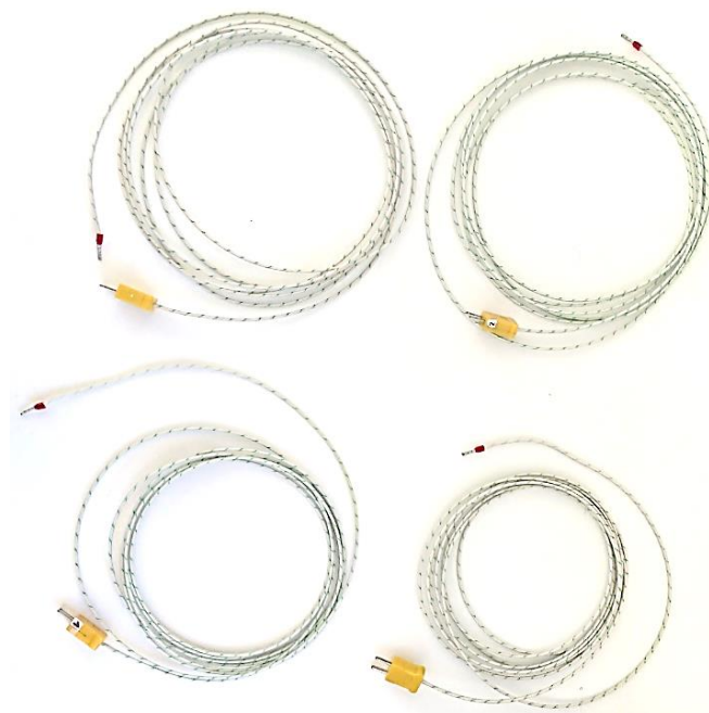
Figura 68 – Termopares tipo K utilizados no molde
