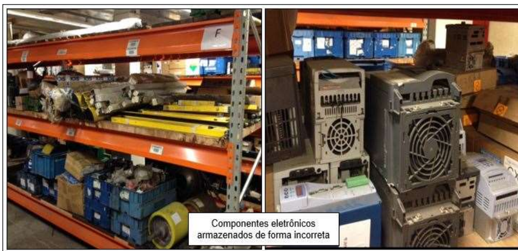
Figura 16 – Componentes Armazenados de Forma Incorreta
